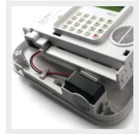
DAS DIE STEUERELEKTRONIK SCHÜTZENDE GEHÄUSE KANN GEDREHT WERDEN, UM DIE KABELANSCHLÜSSE UND DEN ZUGANG ZUM SPEICHER UND ZUR SIM-KARTE DER GSM-VERSIONEN ZU ERLEICHTERN.
