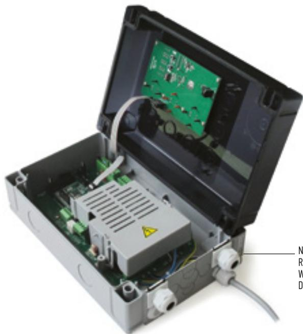
NEUES KUNSTSTOFFGEHÄUSE, DAS ENTWEDER RECHTS- ODER LINKSSEITIG GEÖFFNET WERDEN KANN UND SOMIT PRAKTISCHER IST. DIE OPTIMALE LÖSUNG FÜR KLEINE BEREICHE.
